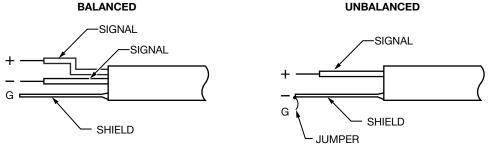
LINE LEVEL BALANCED OR UNBALANCED (5V P/P MAXIMUM AUDIO) A232
